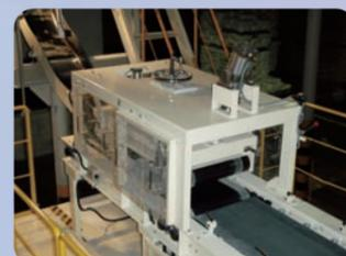
袋製品の成型・脱気をしながら搬送するコンベヤ振動機能を付けることも可能
