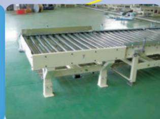
フォークリフトへの載込・払出を行うコンベヤ搬送方向によりローラ・チャンを選定
