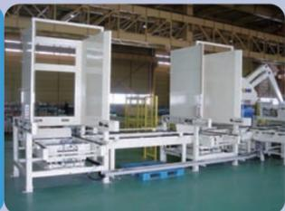
段積みパレットをフォークリフトで投入、一枚ずつ払出してコンベヤラインに供給、一枚ずつのパレットを段積み、パレットスタッカーも可能
