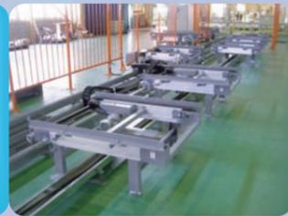
各ステーションコンベヤへ振分け搬送するコンベヤ、搭載横行台車
