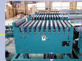
ロボットで製品を掴むところのコンベヤハンドに合わせて都度設計
