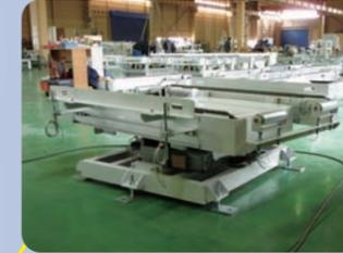
パレットコンベヤの進行方向を90度・180度回転変換
